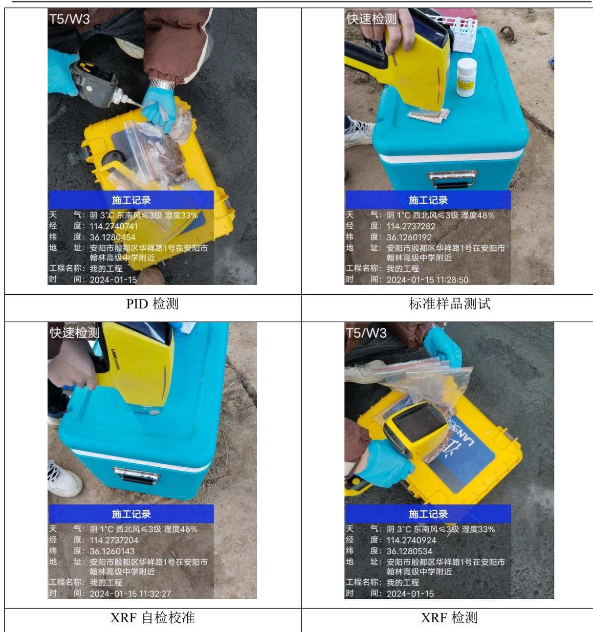
图 4-7 XRF、PID 现场检测
